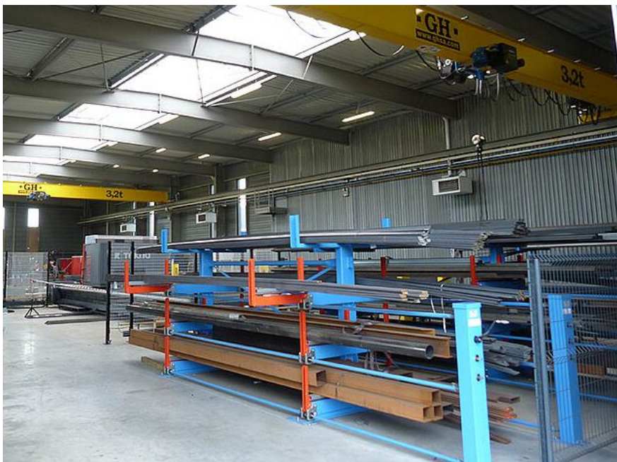
Rack de stockage pour barres avec extraction sur tiroirs par manivelle
