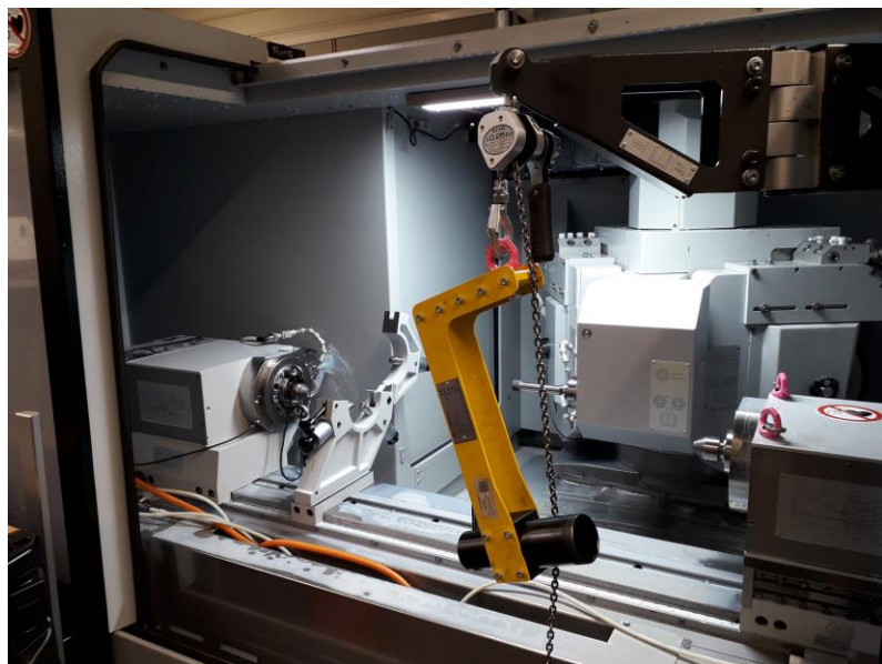
Aide à la manutention intégrée pour le changement des meules
